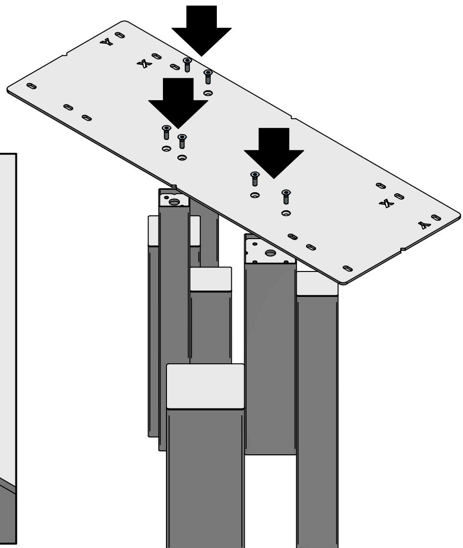
**ATTENZIONE:** la costruzione della base consente alla stessa la possibilità di essere flessibile, di conseguenza le viti che fissano la piastra per l'ancoraggio del piano alla base vanno prima premontate e successivamente fissate con cautela!
