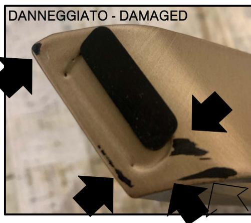
**IT** *Questa parte può danneggiarsi in fase di assemblaggio della base, prestare la massima attenzione proteggendola con del materiale morbido.*
